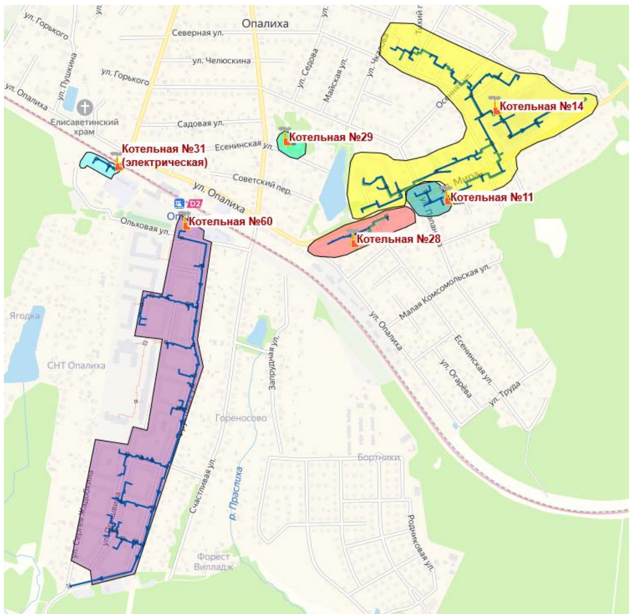
Рисунок 1.4.9 – Зоны действия котельных №11, №14, №28, №29, №31, №60 АО «Красногорская теплосеть»
