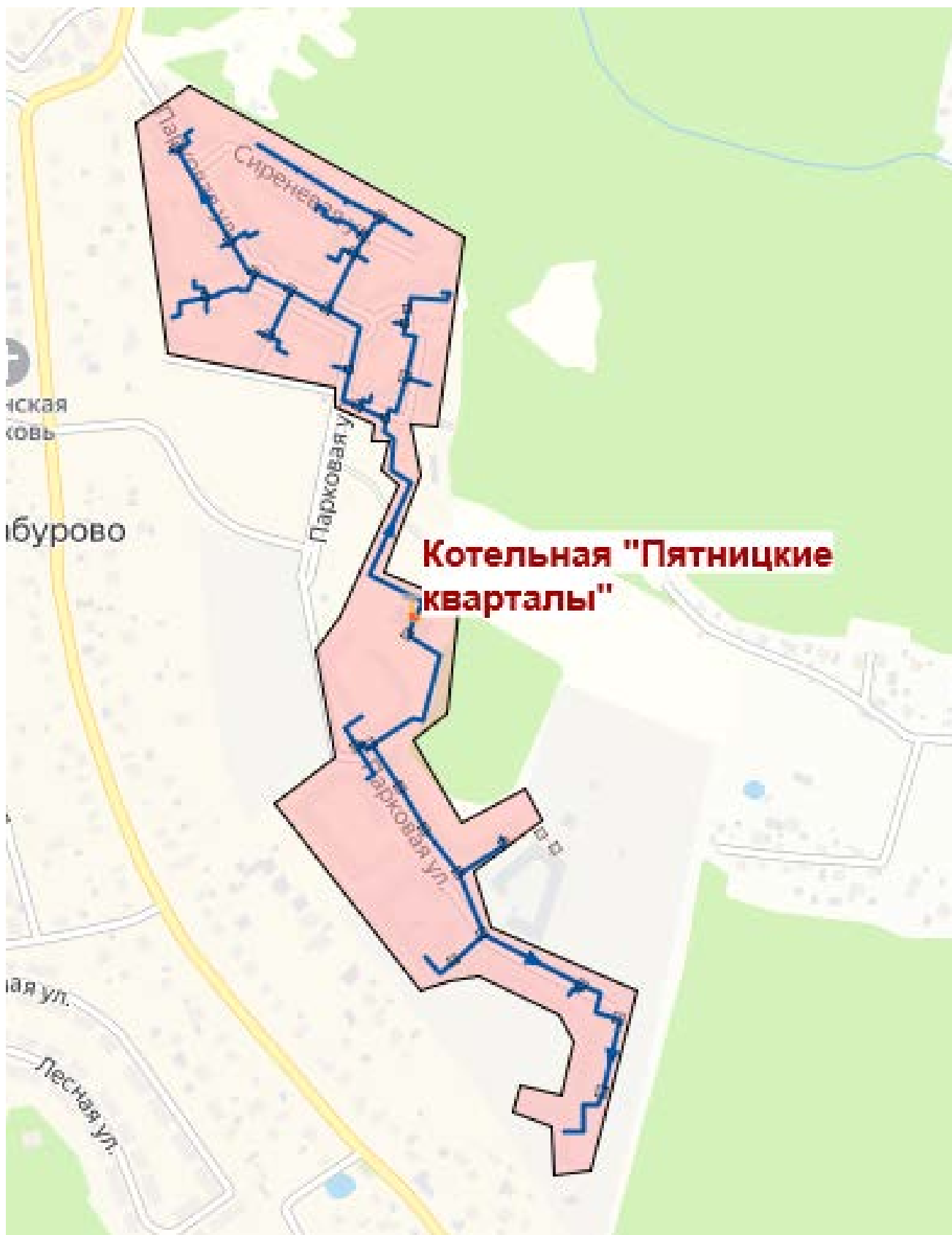
Рисунок 9.5.27 –Карта-схема тепловых сетей котельной «Пятницкие кварталы»
