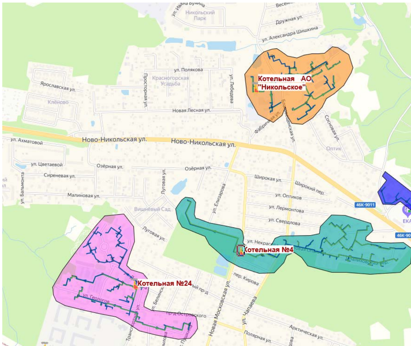
Рисунок 3.2.3 –Тепловые сети котельных №4, №24 АО «Красногорская теплосеть», АО «Никольское»
