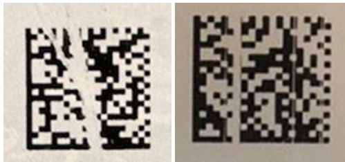
Нарушение целостности КМ*
