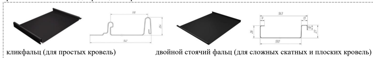
рис. 5.3 «основные виды фальцевой кровли»
