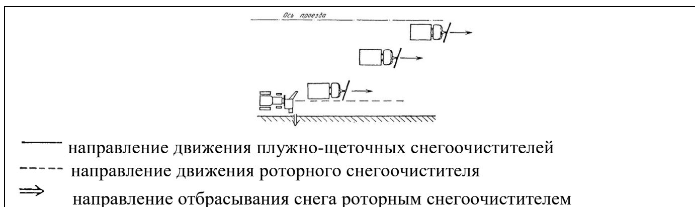
Рис. 6.6. Схема расчистки проезжей части улиц колонной плужно-щеточных снегоочистителей и перекидывание снега роторным снегоочистителем
