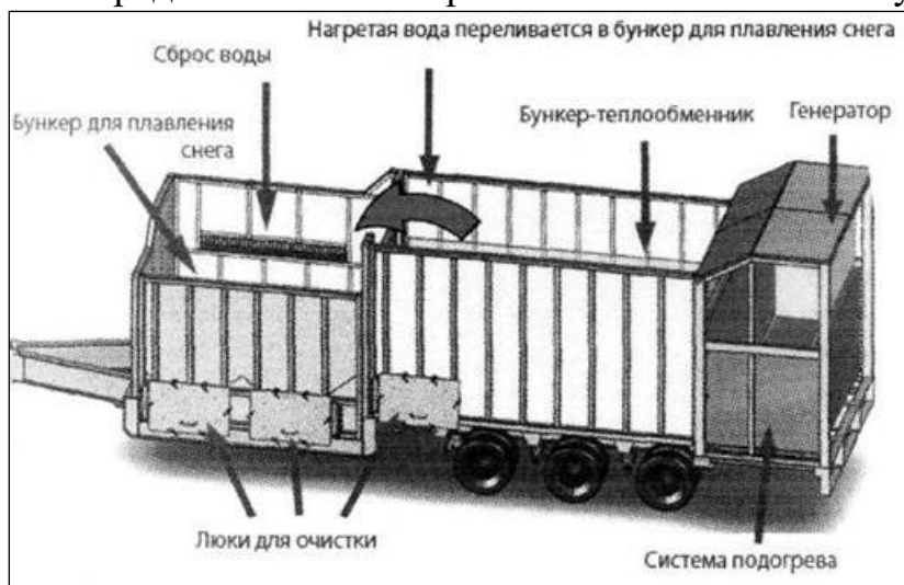
Рис. 6.4. Схема работы снегоплавильной установки
