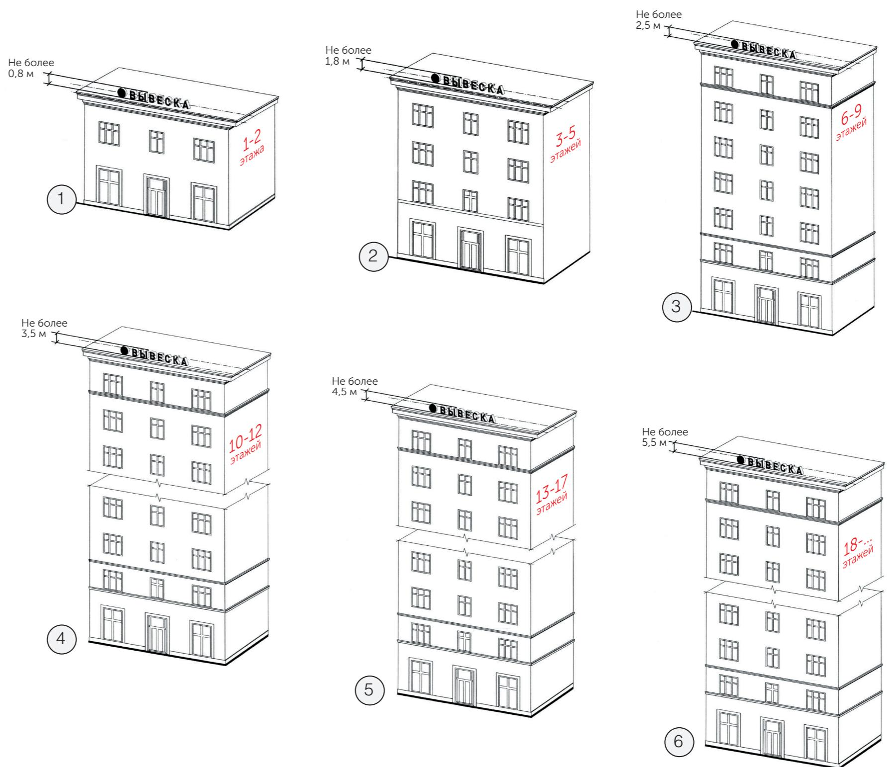
ВЫСОТА ИНФОРМАЦИОННЫХ КОНСТРУКЦИЙ (ВЫВЕСОК), РАЗМЕЩАЕМЫХ НА КРЫШАХ ЗДАНИЙ, СТРОЕНИЙ, СООРУЖЕНИЙ, ДОЛЖНА БЫТЬ:
