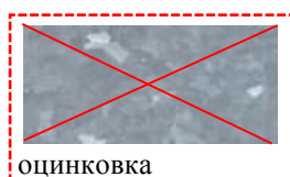
рис. 2.37 «недопустимый вид внешний вид финишного покрытия»
