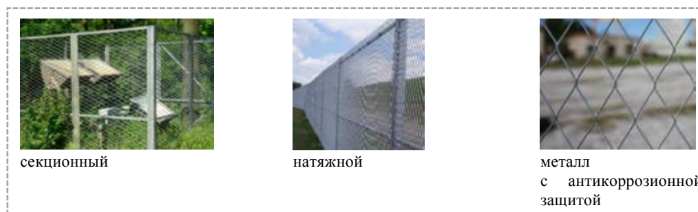
рис. 2.24 «примеры допустимых ограждений из ЦПВС»
