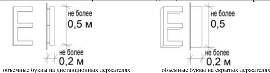
рис. 2.9 «допустимые варианты расположения настенных вывесок на НТО»
