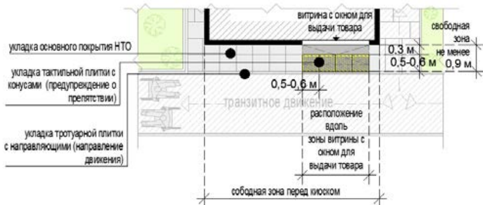
схема сопряжения существующего тротуара, тактильной тротуарной плитки, тротуарной плитки:
