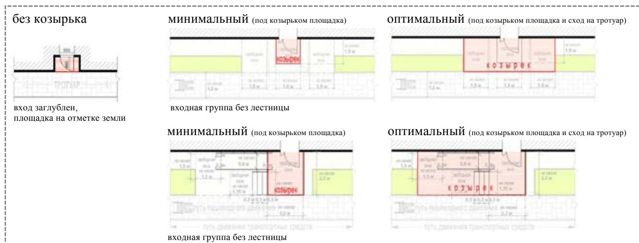
рис. 6.12 «примеры возможного минимального и оптимального расположения козырька относительно площадок, пандусов, лестниц при реконструктивных работах»
