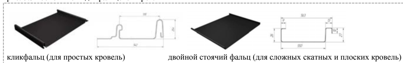
рис. 5.3 «основные виды фальцевой кровли»
