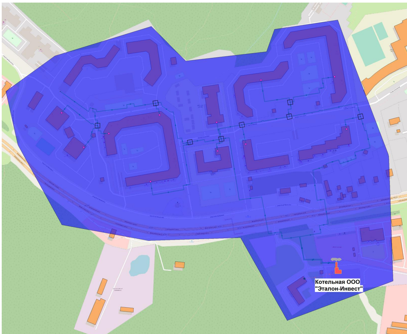
Рисунок 2.2.26 – Зона действия котельной ООО «Эталон-Инвест»
