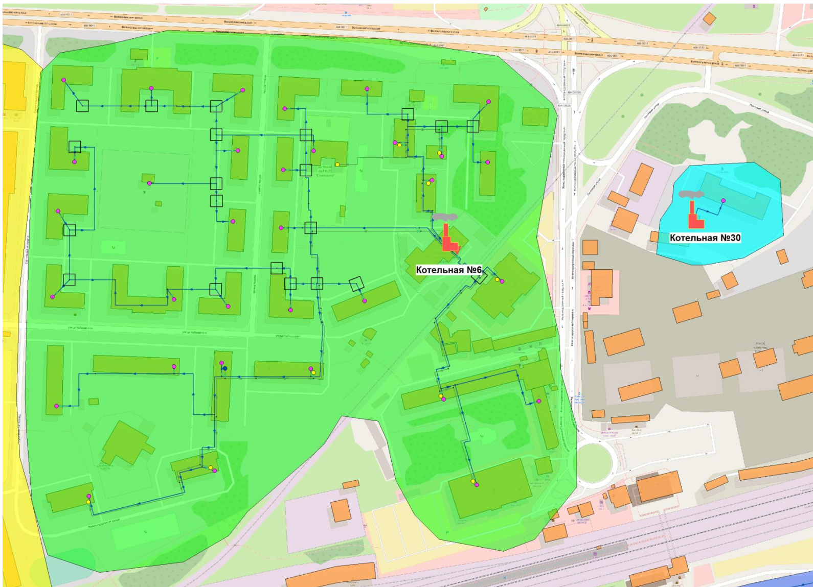
Рисунок 2.2.5 – Зона действия котельной №6 и №30 ПАО «Красногорская теплосеть»
