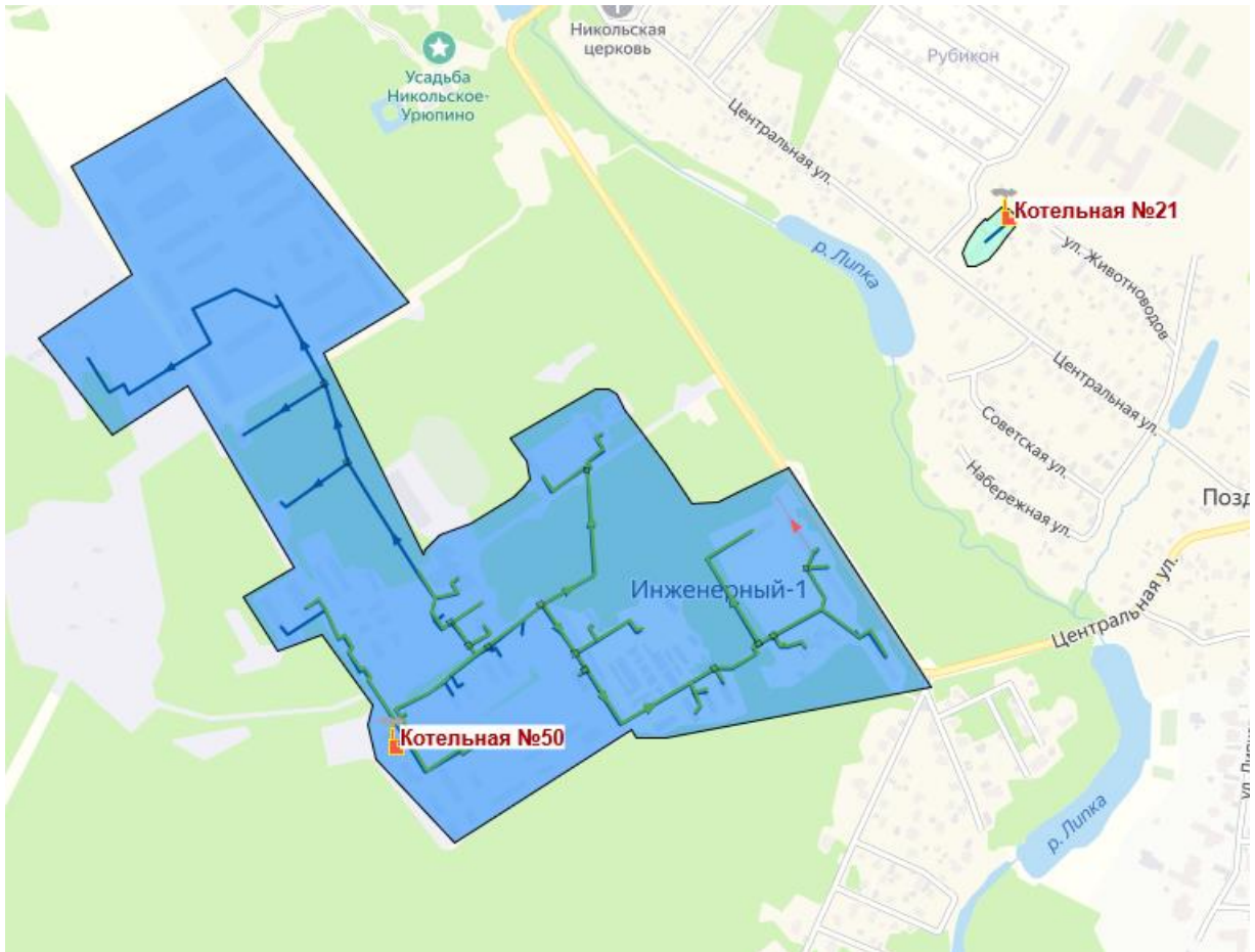
Рис. 3.1.2.3.15. - Зоны действия котельных №21, №50 АО «Красногорская теплосеть»
