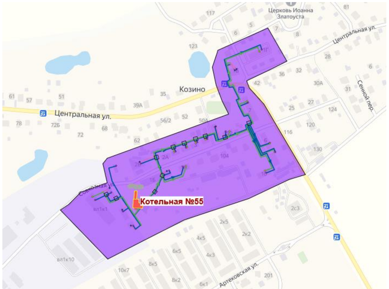
Рис. 3.1.2.3.21. - Зона действия котельной №55 АО «Красногорская теплосеть»
