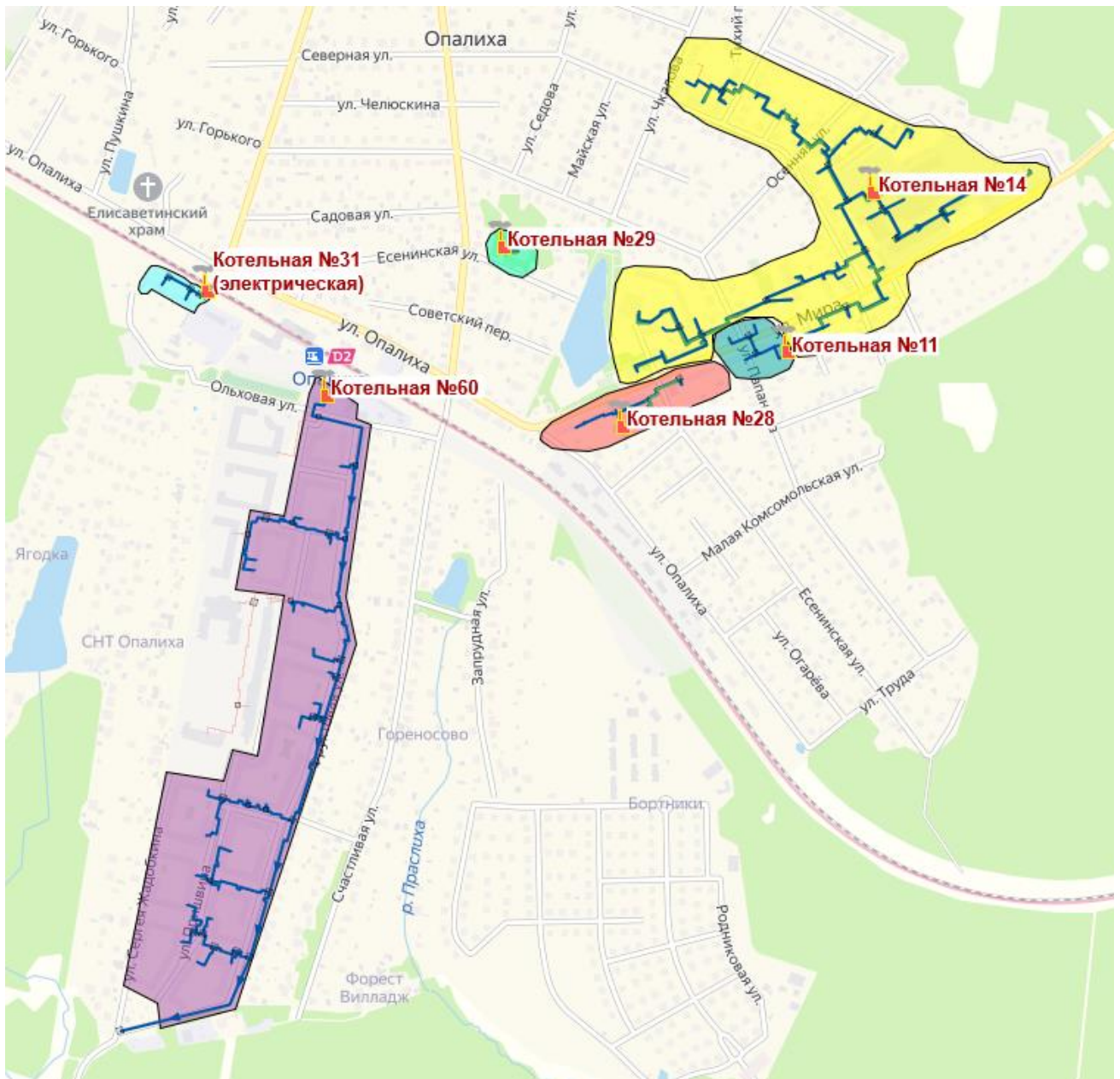
Рис. 3.1.2.3.10. - Зоны действия котельных №11, №14, №28, №29, №31, №60 АО «Красногорская теплосеть»
