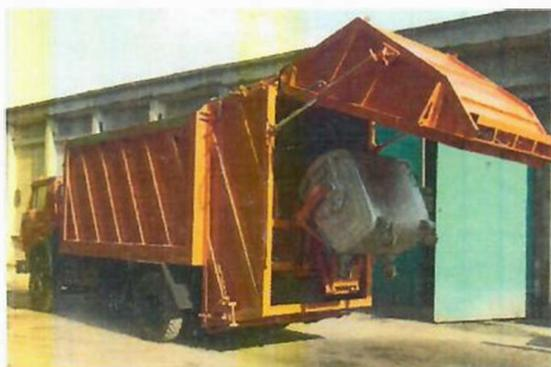
Рисунок 17. Машина для мойки контейнеров марки ТГ–100 на шасси КамАЗ
